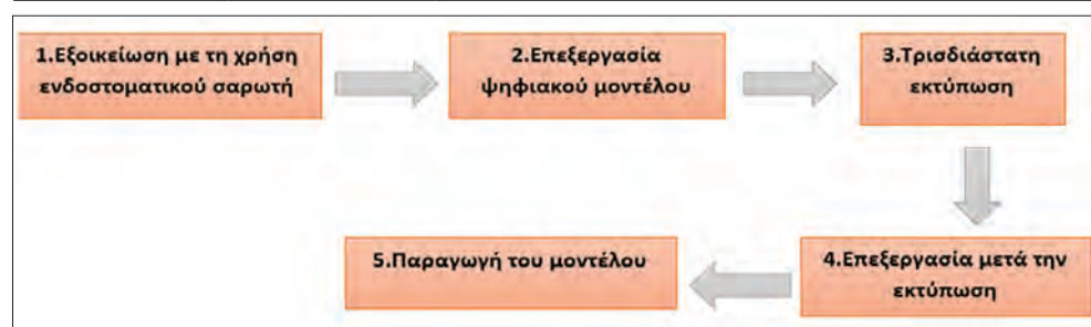
Σχήμα 2: Διάγραμμα 5 βημάτων της τρισδιάστατης εκτύπωσης στην οδοντιατρική ροή εργασίας.
